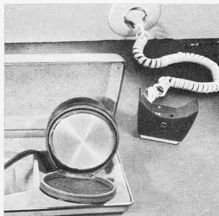
Bild 2. Mittelwellenempfänger IC 2000 mit integrierter Schaltung. Links das eigentliche Empfangsgerät, rechts der zugehörige Netzteil, auf den der Empfangsteil aufgesteckt werden kann (Foto: Schwahn)
